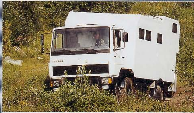
Verschränkt: Hochgeländegängige Expeditionsmobile brauchen einen starken Zwischenrahmen unter der Wohnkabine.
