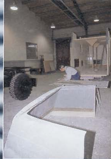
Laminiert: Eigenfertigung von Spoilern, Fendern und Schürzen.
