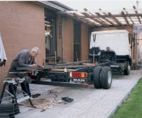
Angepasst: Den Zwischenrahmen schweißt und verschraubt Schröder selbst.
