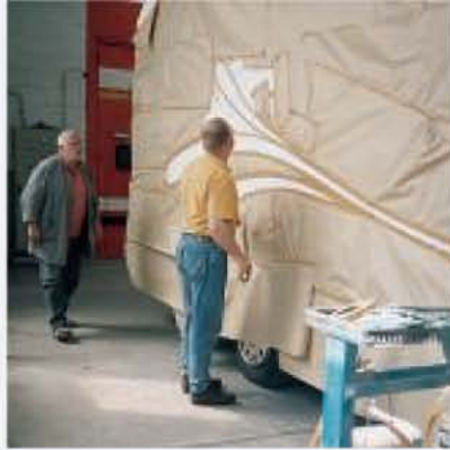
Übertragen: Ein Projektor hat die Konturen des Außendekors auf die Seitenwand geworfen.
