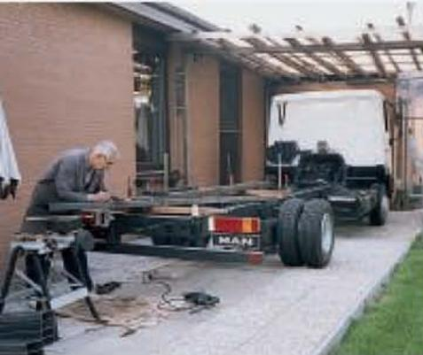
*Angepasst: Den Zwischenrahmen schweißt und verschraubt Schröder selbst.*
