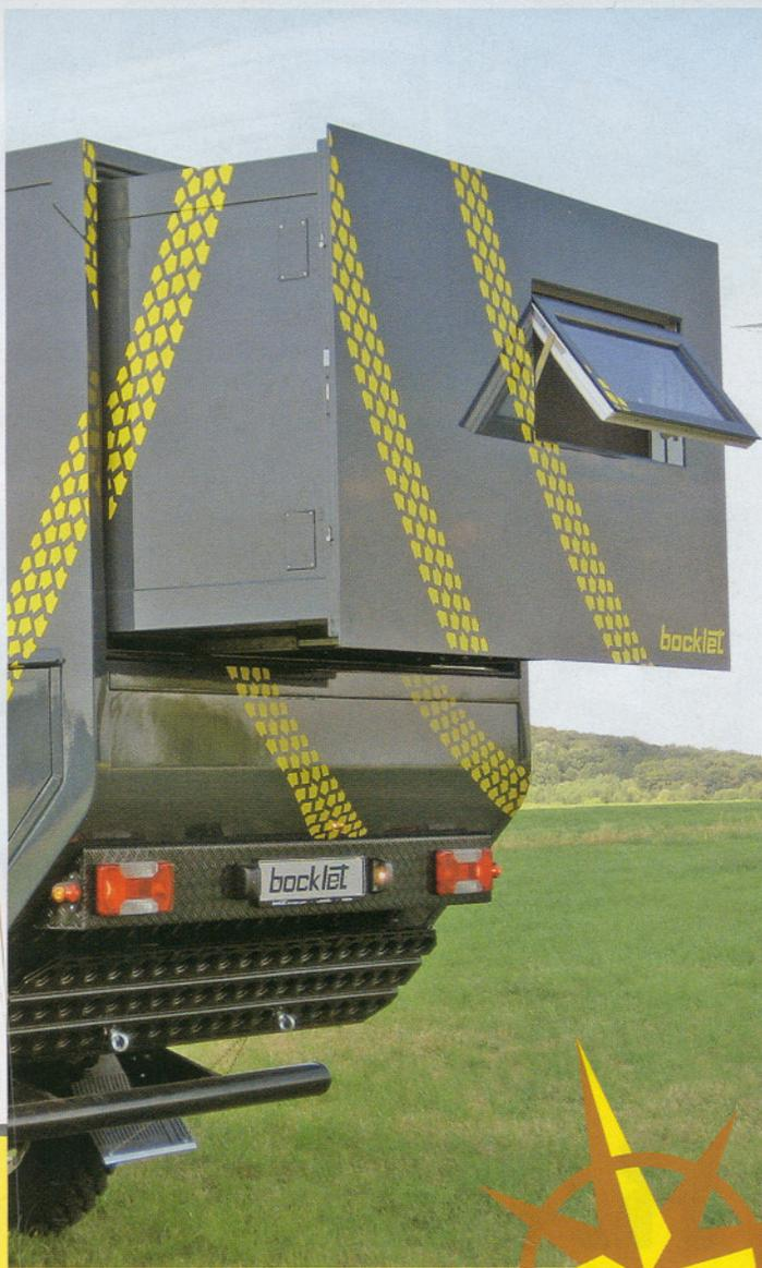
stellten Bocklet Dakar 630. Der Wohnaufbau ist, wie bei der Bocklet Fahrzeugbau GmbH üblich, eine GFK-Sandwich-Konstruktion mit Wand- und Dachstärken von 50 Millimetern (Bodenplatte 60 mm). Türen und Klappen sind kältebrückenfrei, spezielle Stufenprofile und Hohlgummidichtungen schützen vor eindringendem Staub oder Wasser, Mehrfachverriegelungen sorgen für Sicherheit. Um eine hohe Wendigkeit des Fahrzeugs im Gelände zu erreichen, ist die Wohnkabine bewusst kompakt gehalten.
